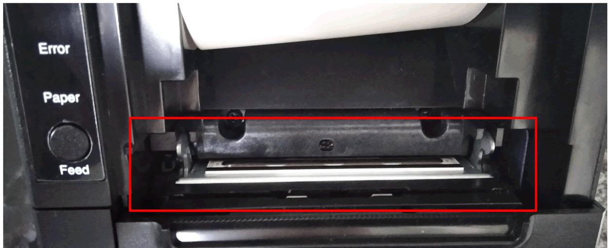
**A cabeça de impressão está localizada na parte inferior da impressora, na parte da frente. Deve-se ter o máximo de cuidado com esta parte da impressora.**
